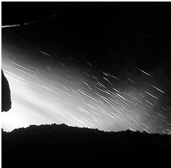
Figura 4 – Granulação de escória de alto-forno na Companhia Siderúrgica de Tubarão
