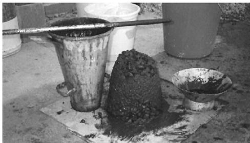
Figura 10 – Aspecto do concreto fresco confeccionado com cinza de casca de arroz com alto teor de carbono
