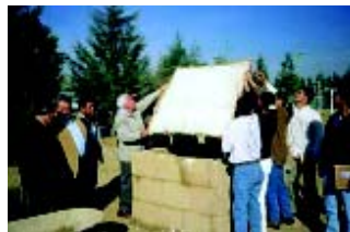
Figura 8 - Cubierta Anti Funicular de la India Modelo Experimental al Momento de Invertir la Cubierta
