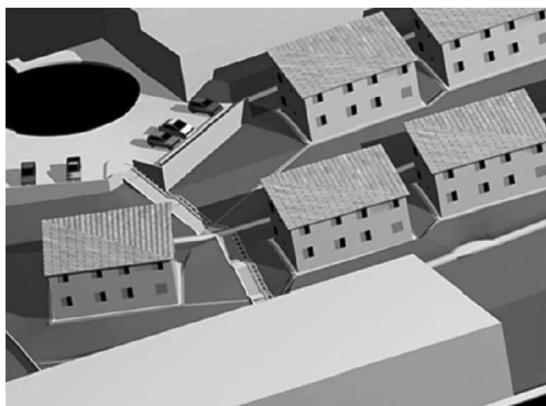
Figura 1- Perspectiva da implantação (versão intermediária) destinada à área situada no Jardim Colinas, observando-se estacionamento (acima, à esquerda), escadarias de acesso e vias longitudinais para pedestres. Observa-se, também, o sistema de drenagem delineado.
