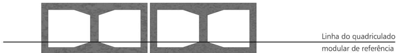
Figura 20 - Componentes em posição assimétrica em relação à linha do quadriculado modular de referência
