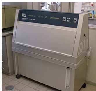
Figura 2: Aparelho QUV de intemperismo acelerado com sistema de radiação e condensação, com controle de temperatura
