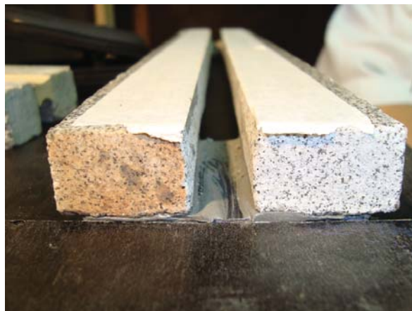
Figura 12: Aplicação fita crepe nas bordas laterais da junta antes da aplicação do selante
