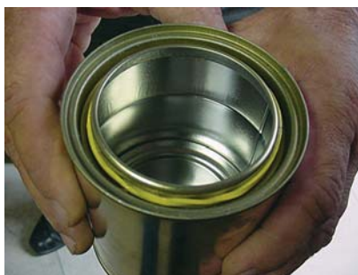
Figura 29: Aplicação de primer na superfície, antes da aplicação do selante
