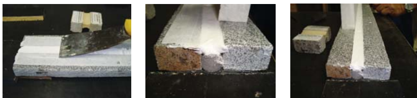
Figura 33: Acabamento da junta com espátula metálica e retirada da fita autoadesiva
