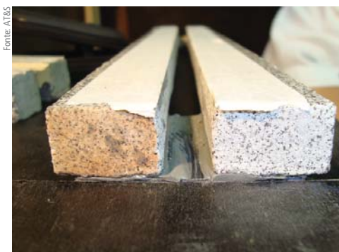
Fonte: AT&S Figura 28: Proteção da superfície com fita autoadesiva
