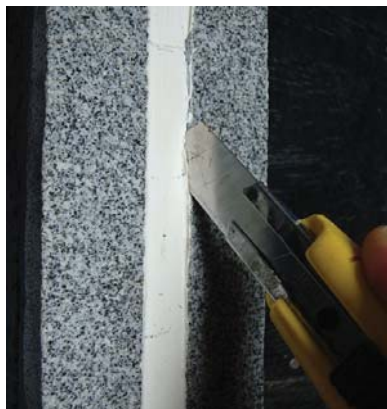
Figura 8: Ensaio de adesão: teste de aderência em campo
