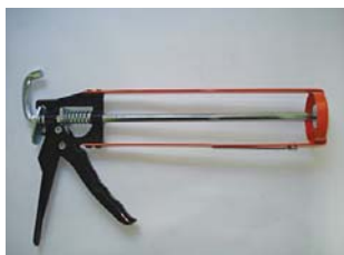
Figura 21: Pistolas para aplicação dos selantes em cartuchos
