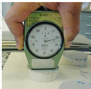
Figura 1: Determinação de dureza usando durômetro “Shore A”
