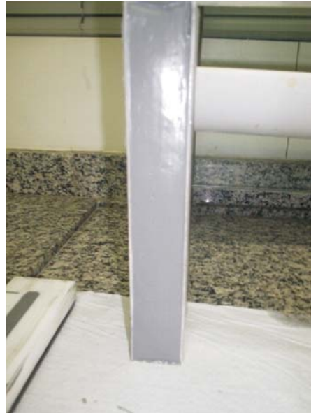
Figura 5: Selante adequado que não apresenta escorrimento, quando aplicado em superfície vertical
