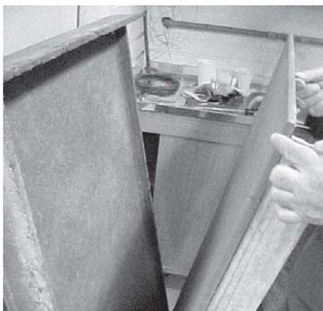
Figura 39: Desmolde do box em GRC
