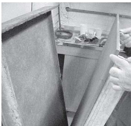
Figura 39: Desmolde do box em GRC
