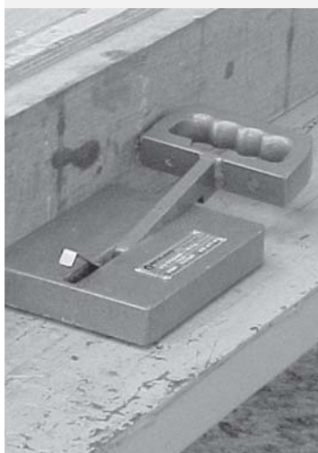
4 - Equipamento de fixação da forma
