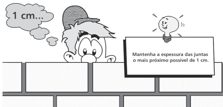
Figura 10 – Detalhe de juntas de argamassa nas alvenarias
