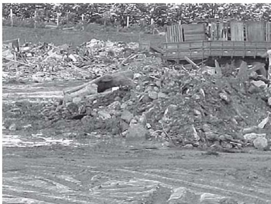
Figura 9 – Mistura de solo com a fração mineral do RCD na usina de reciclagem de Campinas
