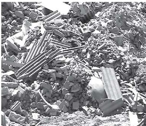
Figura 5 – Telhas de amianto misturadas na fração mineral do RCD, em usina de reciclagem nacional
