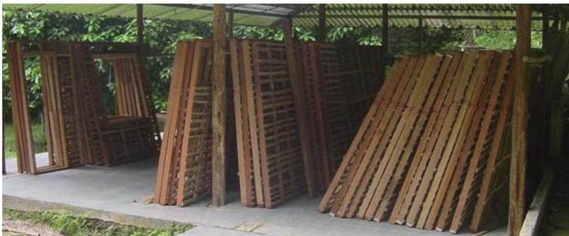
Fabricação e armazenagem dos painéis de parede pré-fabricados na Reserva Florestal Adolpho Ducke.
